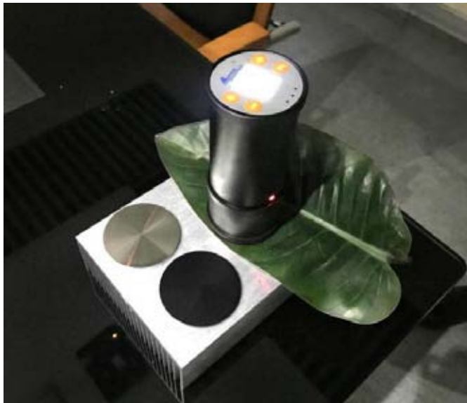
图 12 使用 AE2 进行表面辐射率测试
