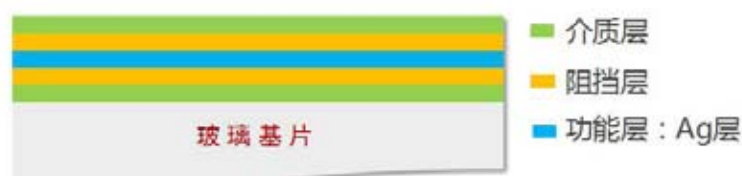
图 1 一层银层---典型单银 Low-E 膜层结构示意图
