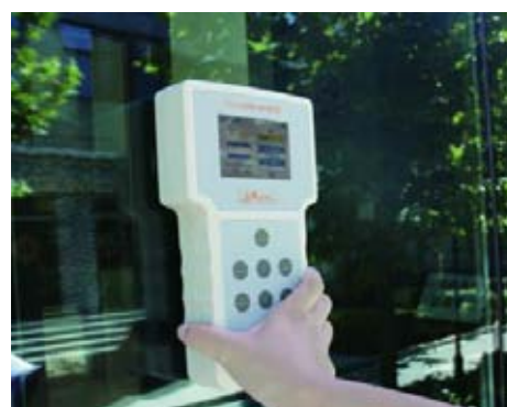
图 6 中空玻璃辐射率计
