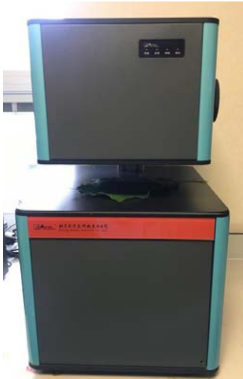
图 8 使用 GlasSpec1000 进行光谱透反射比测试 测试结果如下图 9、图 10 所示：
