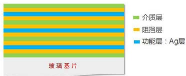
图 3 三层银层---典型三银 Low-E 膜层结构示意图
