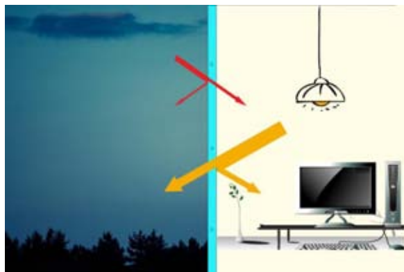
图中红色箭头表示室外光及其透反射光，黄色箭头表示室内光及其透反射光
