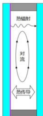
图 2 中空玻璃温差传热机理示意图
