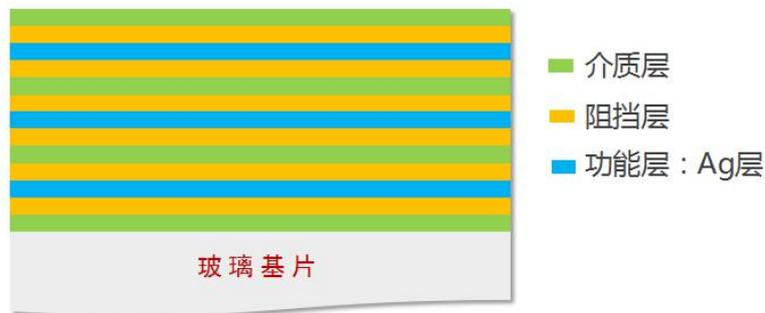
图 4 三层银层——典型三银 Low-E 膜层结构示意图
