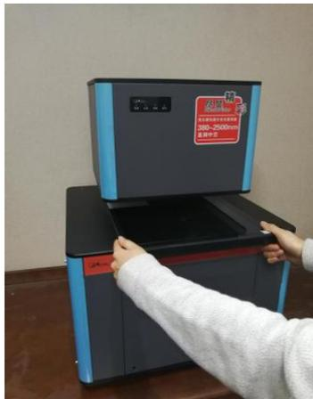
GlasSpec2500 建筑玻璃阳光波段分光光度计
