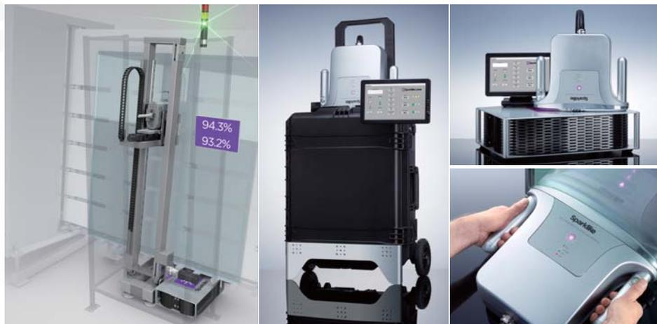
本仪器用于检测节能型双玻单腔或者三玻两腔充气中空玻璃内的惰性气体含量，无需破坏中空玻璃结构或在间隔层内搁置附件，不受镀膜和夹胶片的限制。
