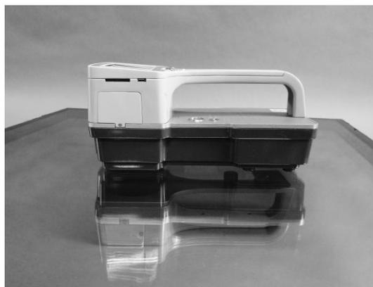
图6 玻璃中部透射测量状态
