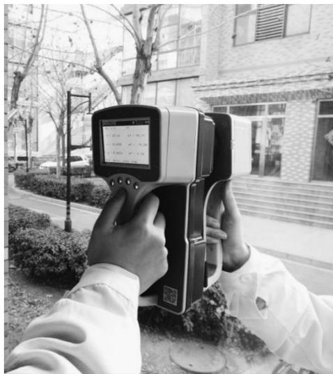
图8 已安装建筑玻璃透射测量状态
