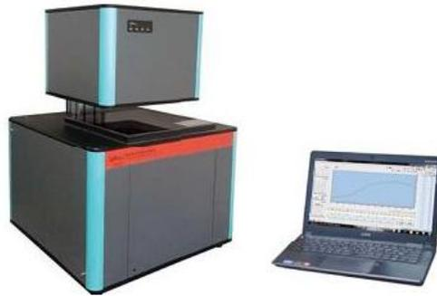
图 3 GlasSpec2500 节能玻璃光热参数综合测试仪
