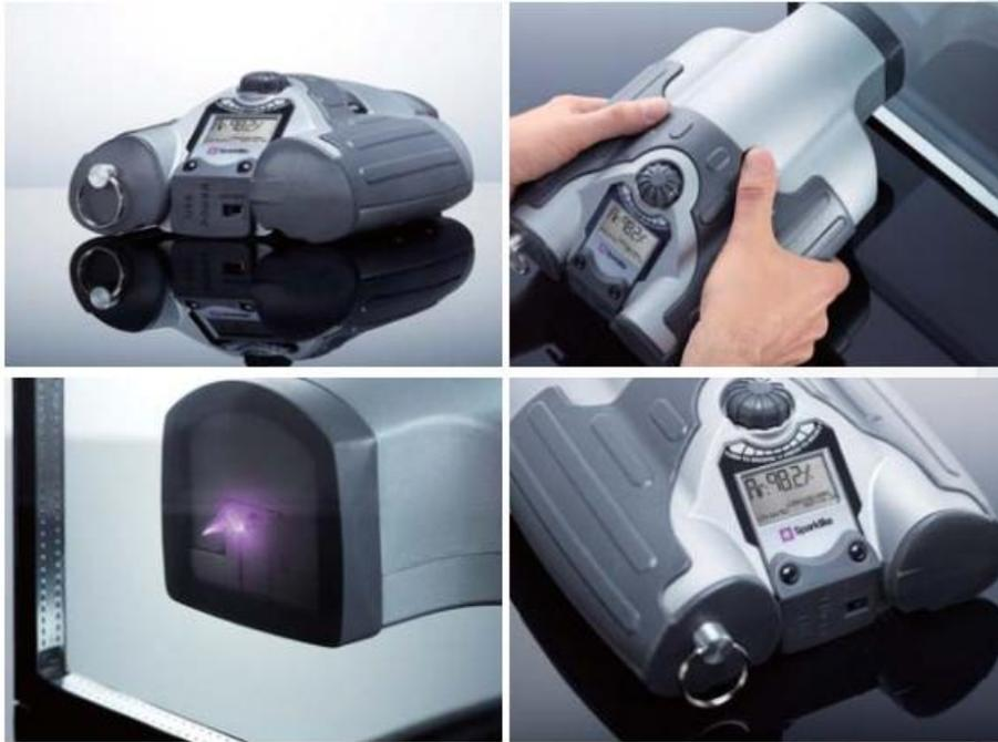
Sparklike 手持式惰性气体分析仪，基于等离子发射光谱技术，测量时间 2 秒
