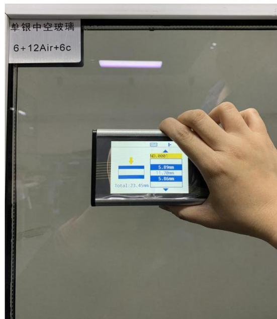
可以看出，在本测试条件下中空腔不同位置的厚度不同，中部的厚度小于边部，即该中空玻璃表面存在一定程度的凹陷。气温为 17℃ 时，中空腔的中部厚度比两边部厚度小约 0.7mm；气温为零下 4℃ 时，中空腔整体厚度有所减小，中部厚度比两边部厚度小约 2.2mm，即中空玻璃表面更加凹陷。
