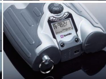
本仪器采用世界上首款无损测量技术, 在不破坏中空玻璃结构的前提下测量其间隔层内惰性气体含量, 如氩气和氪气。
