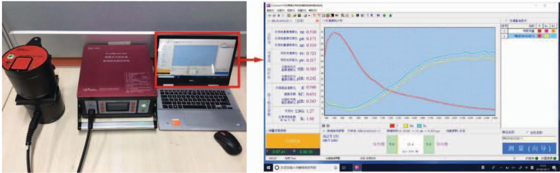
图 6 GlasSmart1000 便携式节能玻璃现场综合测试系统的外观与操作界面
