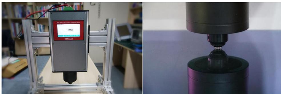
图 3 RD-800 在线四探针面电阻测量仪
