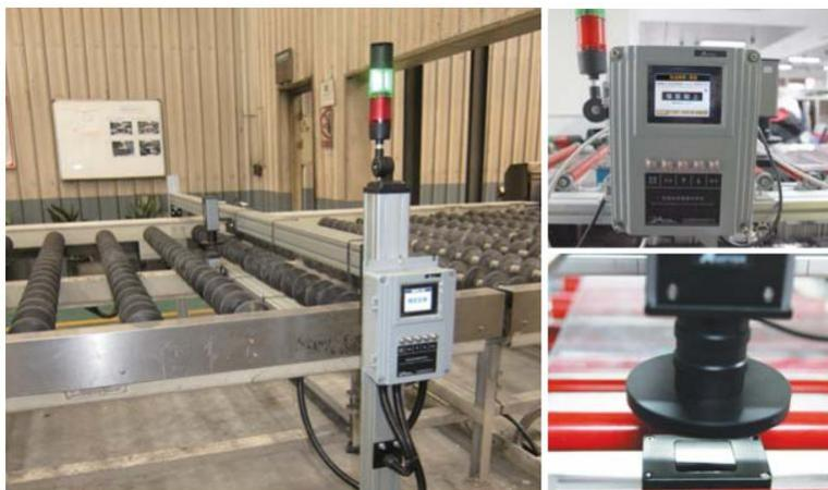
图 3 TS2600 在线自动锡面识别仪
