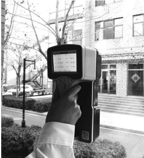
图7 已安装建筑玻璃反射测量状态
