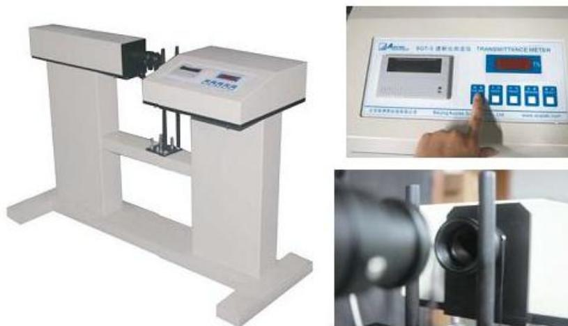
图 5 SGT-3 安全玻璃透射比测定仪
