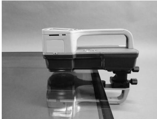
图5 玻璃边部透射测量状态
